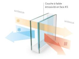
NovaTHERM 80/70, NovaTHERM LUX & NovaTHERM 70/36
