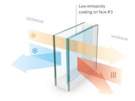
NovaTHERM 80/70, NovaTHERM LUX & NovaTHERM 70/36
